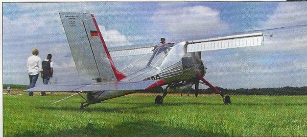
Die Wilga aus dem Hause Frisch ist mit einem 210er-Boxermotor ausgestattet und hat 3.700 Millimeter Spannweite
